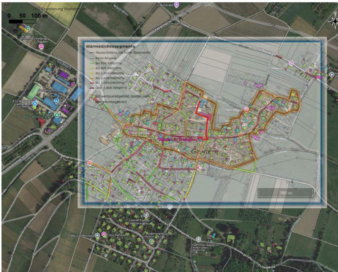
Das Bild zeigt in hellrot das bestehende Nahwärmenetz der BEGS, in orange die Außengrenzen des „Eignungsgebiets für ein heißes Nahwärmenetz“ und in dunkelrot die Wärmedichte, die in den entsprechenden Straßenabschnitten berechnet wurde.
