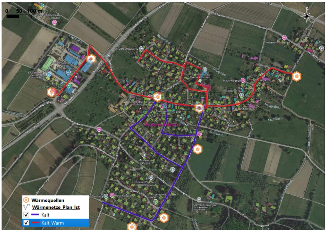
Im Bild sind ein potenzielles Nahwärmenetz in Rot dargestellt, das als heißes oder kaltes Nahwärmenetz entstehen könnte, und ein Versorgungsgebiet, das wegen der geringeren Wärmedichte eher als kalter Nahwärme ausgelegt würde (in blau/violett dargestellt).
